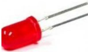
Une LED (Light Emitting Diode) est une diode qui émet de la lumière lorsqu'elle est parcourue par un courant continu dans le sens passant.
