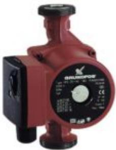
Le circulateur, c'est la pompe qui déplace l'eau entre la chaudière et le radiateur. Elle se trouve en chaufferie. Elle peut fonctionner sur 3 vitesses différentes. Si cette pompe tourne trop vite, elle fera tourner l'eau trop vite en pure perte... Sa consommation sera trop élevée pour les besoins.
