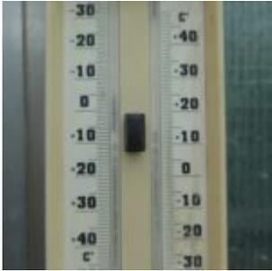
Un thermomètre équipé d'une fonction Minima-Maxima peut être déposé sur le radiateur et recouvert d'un tissu pour que sa température soit proche de celle de l'eau. Si pendant la nuit la température minima ne descend pas sous les 25°C, c'est que le chauffage n'est pas coupé !
